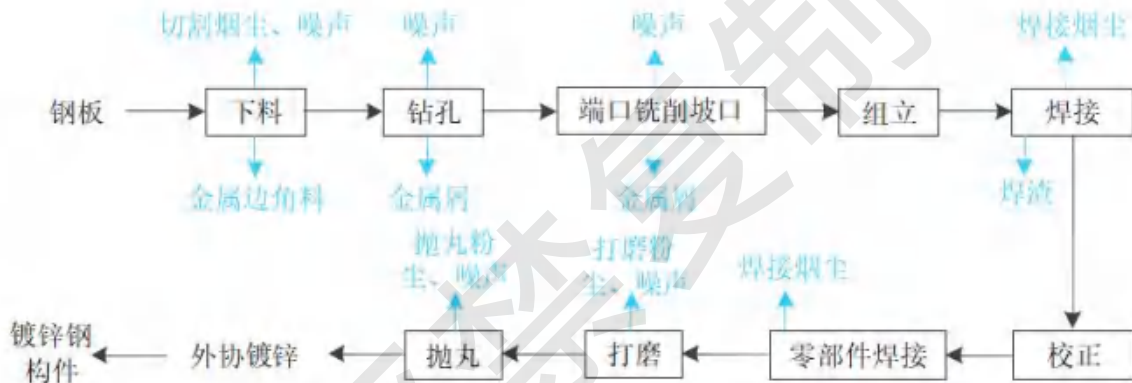
图 3.6-1 项目镀锌钢构件（钢板原料）生产工艺流程和产污节点图
