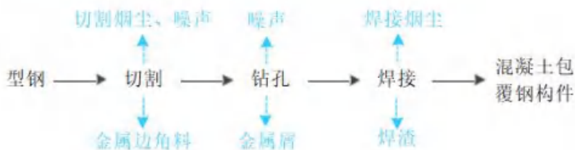
图 3.6-3 项目混凝土包覆钢构件（型钢原料）生产工艺流程和产污节点图
