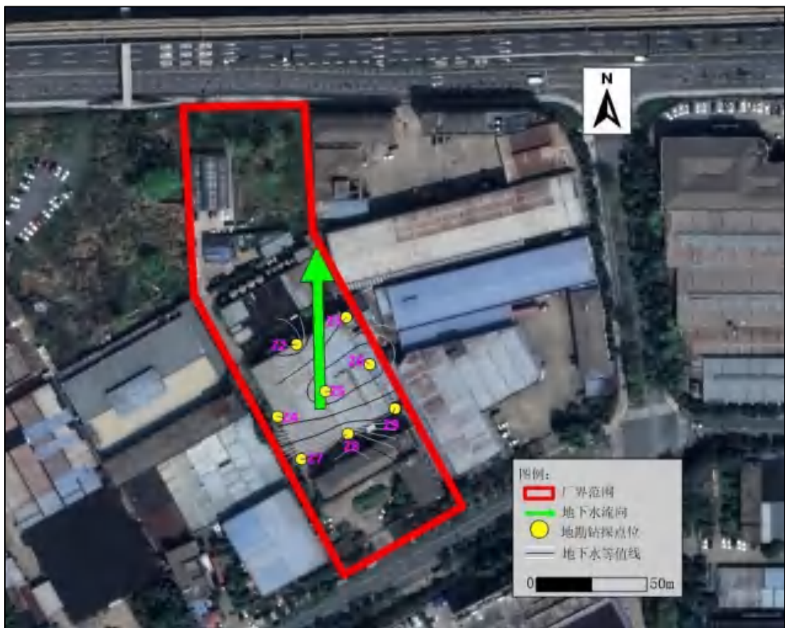
图 3.2-1 地下水位流向图
