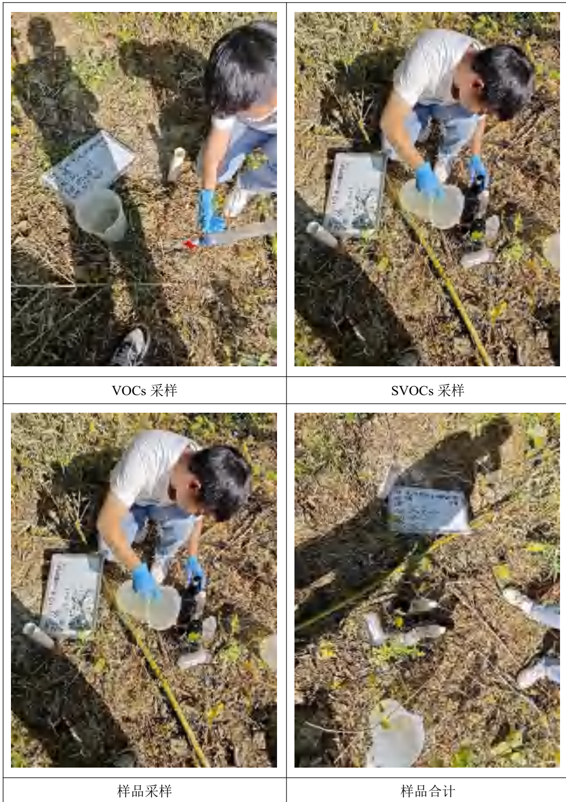
图 7.3-2 地下水采样照片
