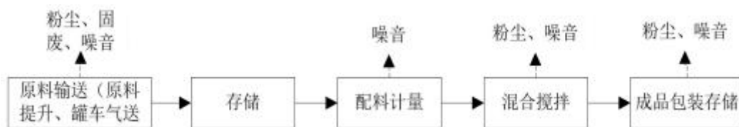
图 2-2 腻子粉、抹灰石膏生产工艺流程及产污流程图
