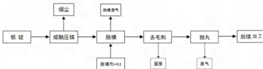
图 2-1 压铸工艺流程及产污流程图
